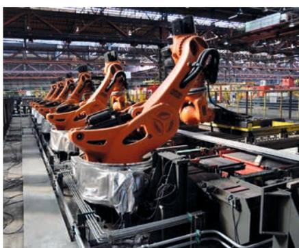
*Roboter bündeln die automatisch gewalzten Stahlprofile bei der Firma Mannstaedt.*
