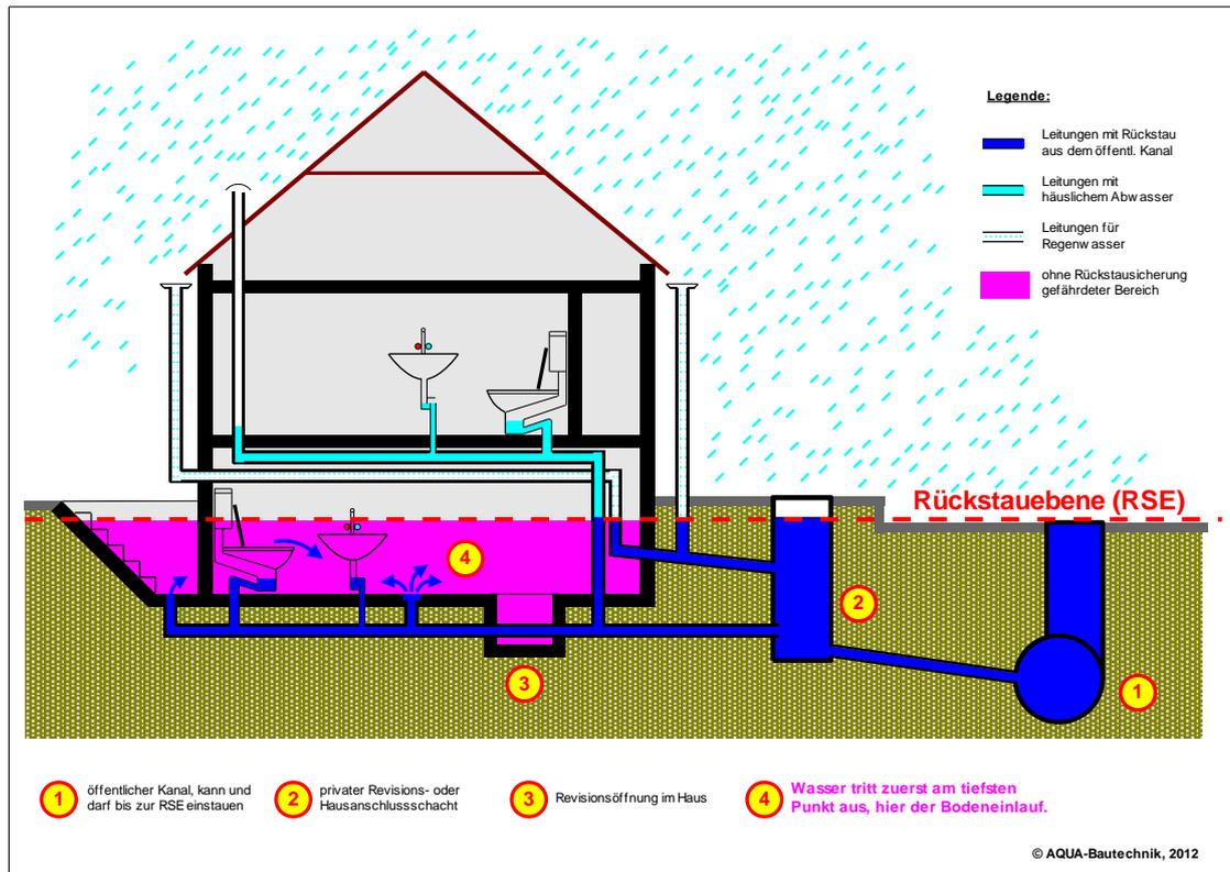
Bei hoher Auslastung des öffentlichen Kanals steigt der Wasserspiegel im Kanalrohr bis über die Höhe des Kellerfußbodens. Wenn es jetzt ungesicherte Abläufe oder undichte Stellen in den Rohren gibt, tritt das Wasser in großen Mengen im Keller aus. Wir haben ausgebaute Keller gesehen, bei denen das Abwasser bis 10 cm unter der Kellerdecke stand.
