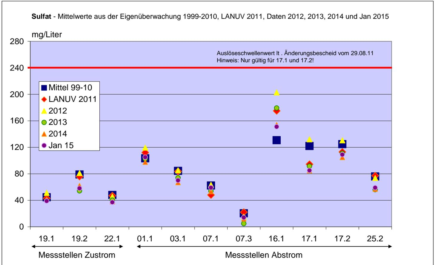
Werden die Auslöseschwellen in Grundwasserproben der beiden Messstellen überschritten, dann muss die MINERALplus GmbH als Betreiber Maßnahmen zum Grundwasserschutz mit der Bezirksregierung Köln als Überwachungsbehörde abstimmen und umsetzen. Für die Messstellen B17.1 und B17.2 wurden Auslöseschwellen für insgesamt 6 Parameter festgelegt:
