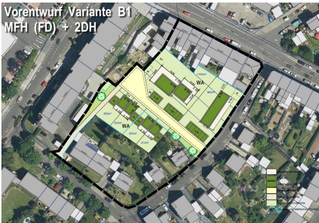
Abbildung 3: Geltungsbereich des B-Plan T19, 18. Änderung (schwarze Strichellinie), und die Aufteilung von Baufeldern und Festsetzungen gem. der weiterverfolgten Variante B. Die Untervarianten B1 und B2 unterscheiden sich nur in der zulässigen Dachform des Mehrfamilienhauses im Nordwesten (hier die Variante B1 mit Flachdach dargestellt). In der Variante B2 ist ein Giebeldach zulässig). (Quelle: Stadtplanungsamt Troisdorf).
