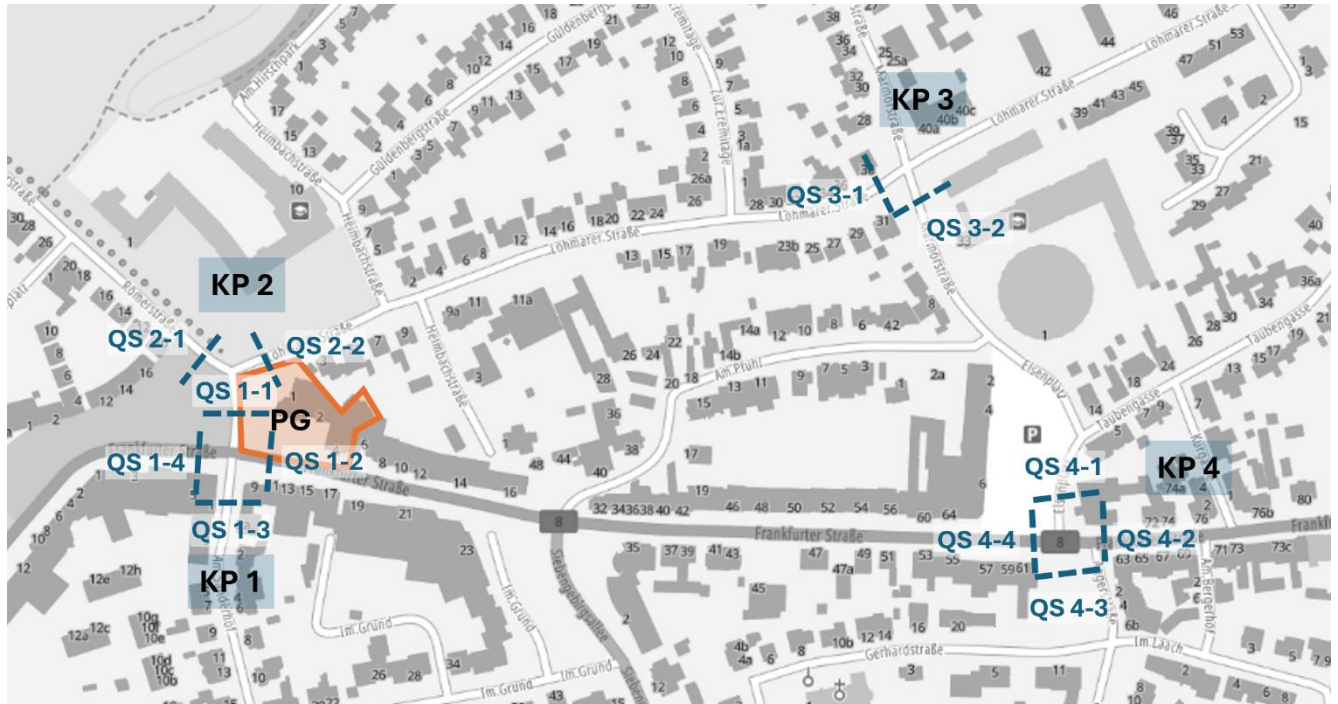
Bild 5: Querschnitte für die Lärmberechnung (Kartengrundlage: TIM-online)
