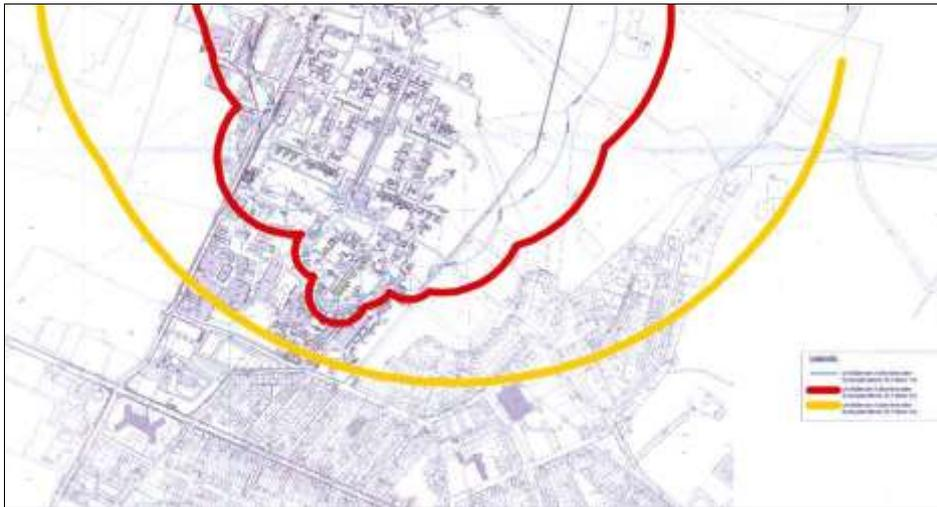
Abb. 2: K44-Linie (gelb) und K22-Linie (rot) nach der 2.SprengV (Störfallbetrieb „Troisdorf Genehmigungshalter mbH (TGHG)“)
